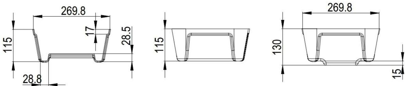
Gutter thủy canh của chúng tôi bao gồm đầu giữa, được thiết kế để dễ dàng kết nối nhiều phần máng xối với nhau, từ đầu đến cuối. Có những thiết kế cuối nam và nữ, đầu nữ dưới lớp dưới sự chống chéo của nam giới để phù hợp với khí khi kết nối các khay. Sử dụng chất kết dính ABS phù hợp để gắn chặt đầu vào đầu nam trên đầu của đầu nữ. Điều này cho phép một bề mặt phát triển độ dài không giới hạn trên nhiều mảnh khay.
