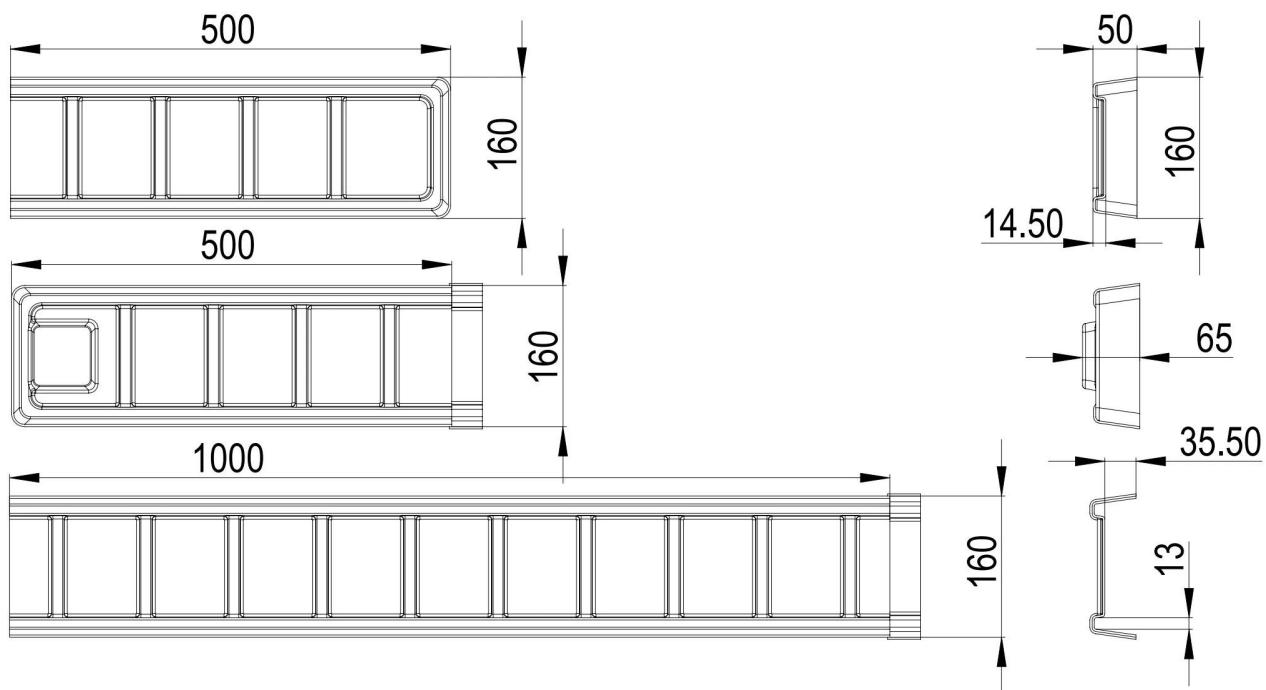
Gutter thủy canh của chúng tôi bao gồm đầu giữa , được thiết kế để dễ dàng kết nối nhiều phần máng xối với nhau, từ đầu đến cuối. Có những thiết kế cuối nam và nữ, đầu nữ dưới lớp dưới sự chống chéo của nam giới để phù hợp với khít khi kết nối các khay. Sử dụng chất kết dính ABS phù hợp để gắn chặt đầu vào đầu nam trên đầu của đầu nữ. Điều này cho phép một bề mặt phát triển độ dài không giới hạn trên nhiều mảnh khay.
