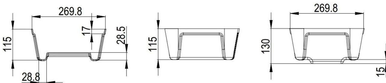
Наш гидропонный желоб состоит из Head Mid End, которая предназначена для легко соединения множественной части желоба вместе, сквозной. Существуют мужские и женские конечные дизайны, женские конечные гнезды под мужским перекрытием для плотного прилегания при соединении лотков. Используйте подходящий клей ABS, чтобы крепко прикрепить мужской конец на верхней части женского конца. Это позволяет увеличить поверхность на уровне неограниченной длины на множественных кусочках подноса.
