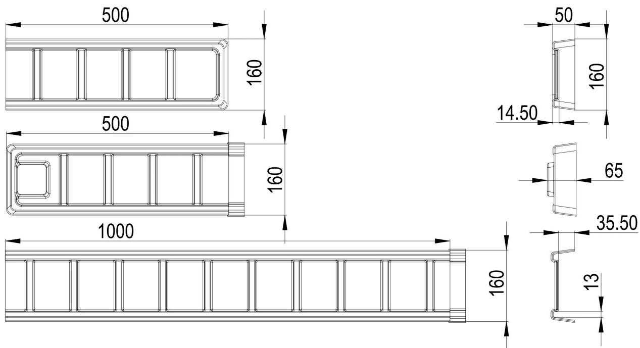
Наш гидропонный желоб состоит из Head Mid End, которая предназначена для легко соединения множественной части желоба вместе, сквозной. Существуют мужские и женские конечные дизайны, женские конечные гнезда под мужским перекрытием для плотного прилегания при соединении лотков. Используйте подходящий клей ABS, чтобы крепко прикрепить мужской конец на верхней части женского конца. Это позволяет увеличить поверхность на уровне неограниченной длины на множественных кусочках подноса.
