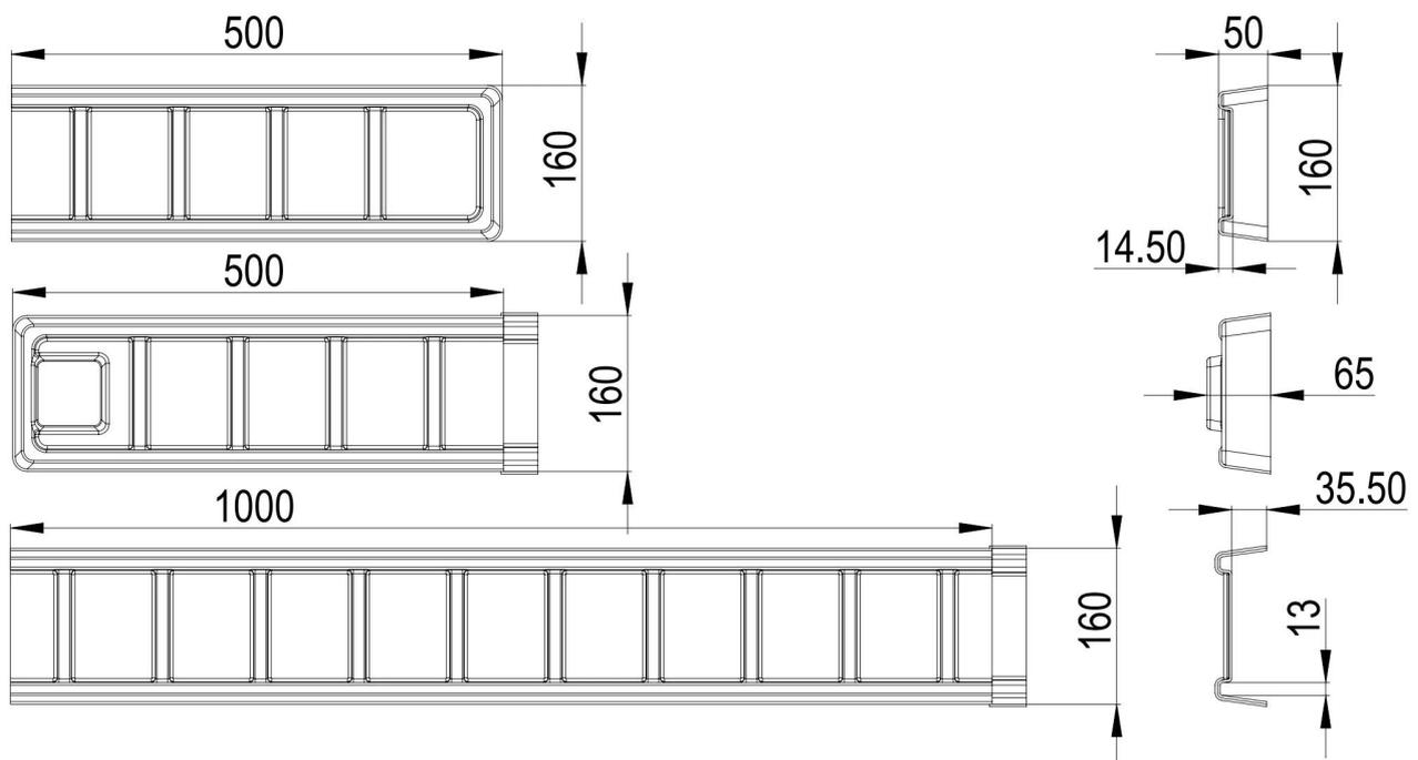
Наш гидропонный желоб состоит из Head Mid End, которая предназначена для легко соединения множественной части желоба вместе, сквозной. Существуют мужские и женские конечные дизайны, женские конечные гнезды под мужским перекрытием для плотного прилегания при соединении лотков. Используйте подходящий клей ABS, чтобы крепко прикрепить мужской конец на верхней части женского конца. Это позволяет увеличить поверхность на уровне неограниченной длины на множественных кусочках подноса.
